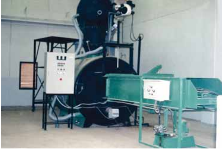
صورة رقم 7: حراق يتكون من حجرة مزدوجة للتحويل الحراري ذو حرارة عالية.
