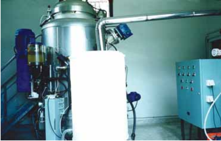
صورة رقم 8: نظام تعقيم بواسط البخار مع ماكينة تقطيع (Shredder).
