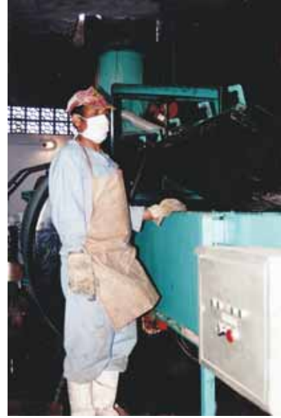
صورة رقم 11: ملابس حماية للعامل المسؤول عن تعبئة أكياس النفايات في المكان المخصص في الحرق. صورة رقم 12: ملابس حماية للحد من خطر العدوى والإصابة بالجروح بالنسبة للمعنيين بحمل ومناولة النفايات
